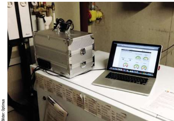
Das Messsystem visualisiert die Temperaturverteilung auf der Bedienoberfläche.
